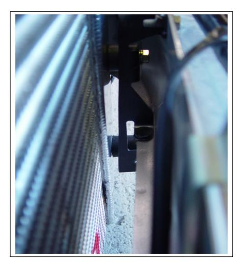
10. FITTING OF THE 100MM X 2.25" SILICON SUPPLIED. USING THE ORIGINAL CLAMPS ENSURE THE TENSIONING SCREW IS REARWARD OF THE SILICON JOIN TO ALLOW CLEARANCE FOR HEADLIGHT BASE AS PICTURED BELOW.
