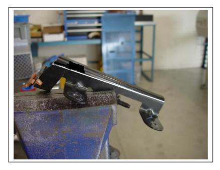
9. PROCEED TO SCREW THE 2 RUBBER STAYS INTO THE LEFT HAND (PASSENGER SIDE) TANK. FASTEN THE M8 NUTS ON THE OPPOSITE ENDS OF RUBBER STAYS TO THE TRIMMED ORIGINAL BRACKET.
