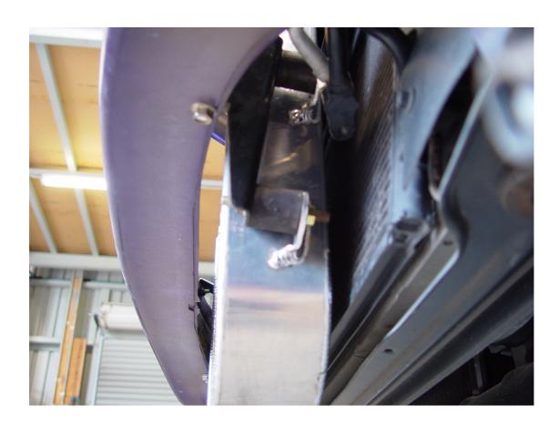
10. FITTING OF THE 100MM X 2.25" SILICON SUPPLIED. USING THE ORIGINAL CLAMPS ENSURE THE TENSIONING SCREW IS REARWARD OF THE SILICON JOIN TO ALLOW CLEARANCE FOR HEADLIGHT BASE AS PICTURED BELOW.
